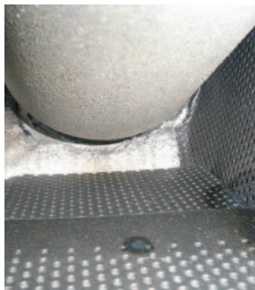
Перфорированная внутренняя стенка неоригинального глушителя
