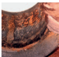
Коррозия и поломка ушка рессоры из-за недостаточной обработки поверхности
